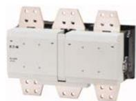
**Силовой контактор; 3-полюсный + 2 замыкающих контакта + 2 размыкающих контакта; 2200 А/AC1**
